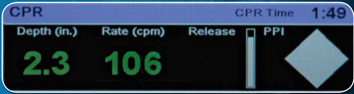
CPR Dashboard ist ein Echtzeifenster im Display mit den wichtigsten Informationen zu qualitativ hochwertigen Kompressionen.
